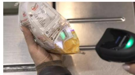
GreenSpot™绿点技术让客户在成功阅读条码的同时振动器提供了优秀的成功读码反馈。
